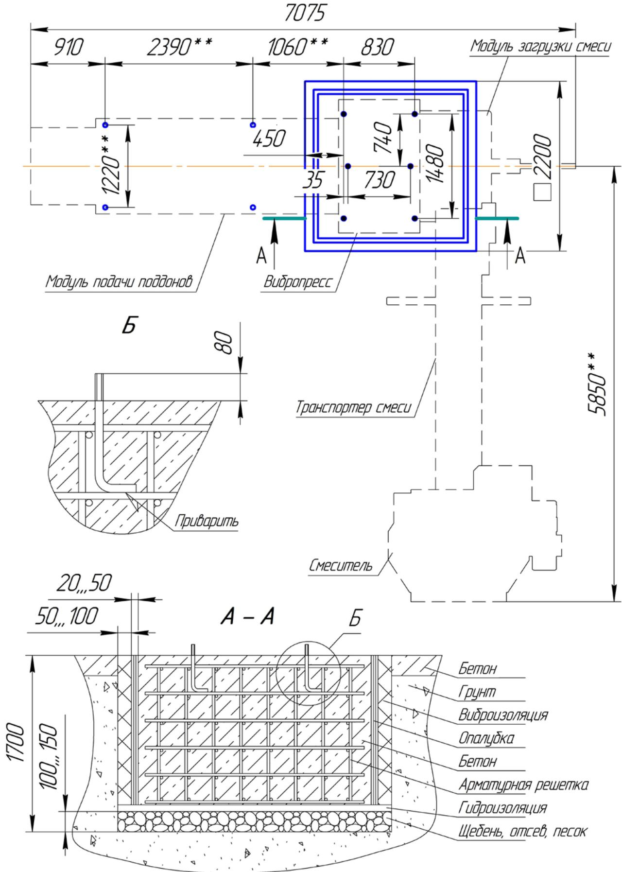
Рисунок 26. Схема фундамента комплекса.
