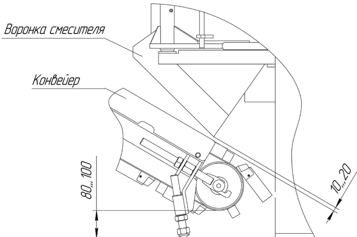
Рисунок 8. Настройка зазора между смесителем и конвейером.
