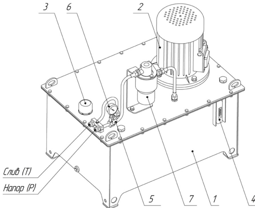
Рисунок 18 – Установка насосная
