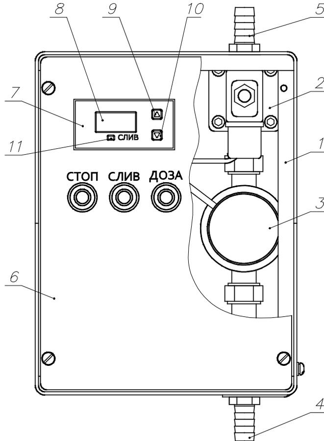
Рисунок 5. Дозатор воды.
