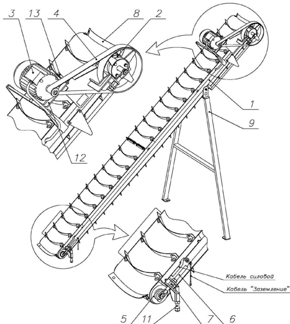
Рисунок 6. Конвейер смеси.
