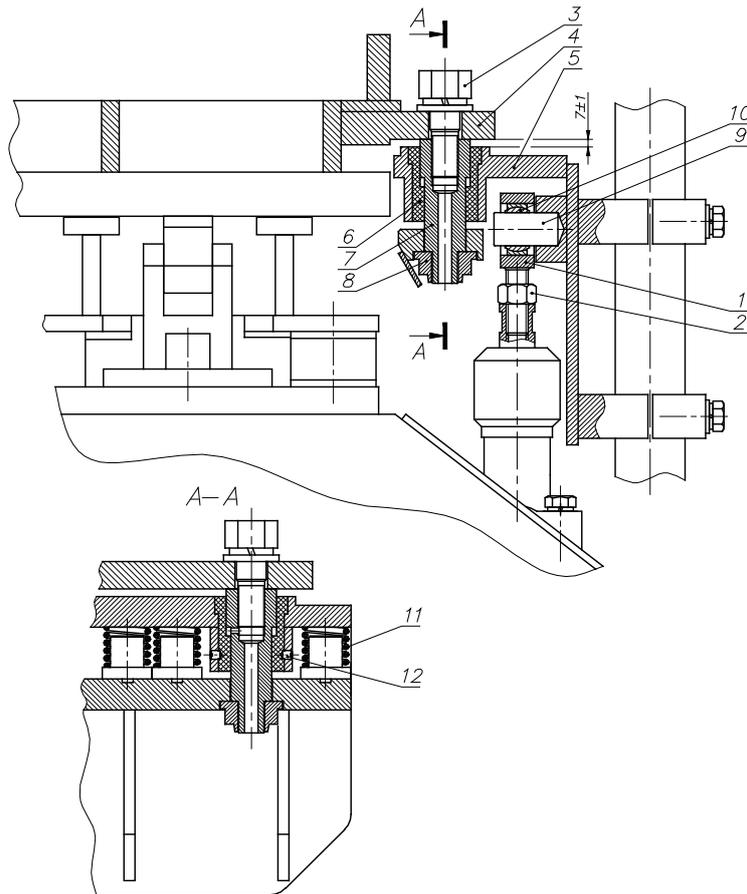
Рисунок 27. Схема настройки прижима матрицы.
