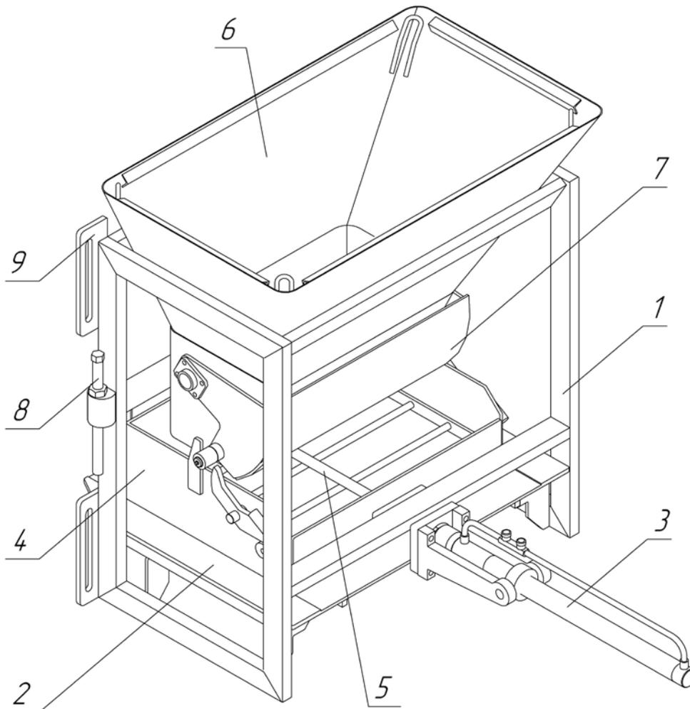
Рисунок 13. Модуль загрузки смеси.
