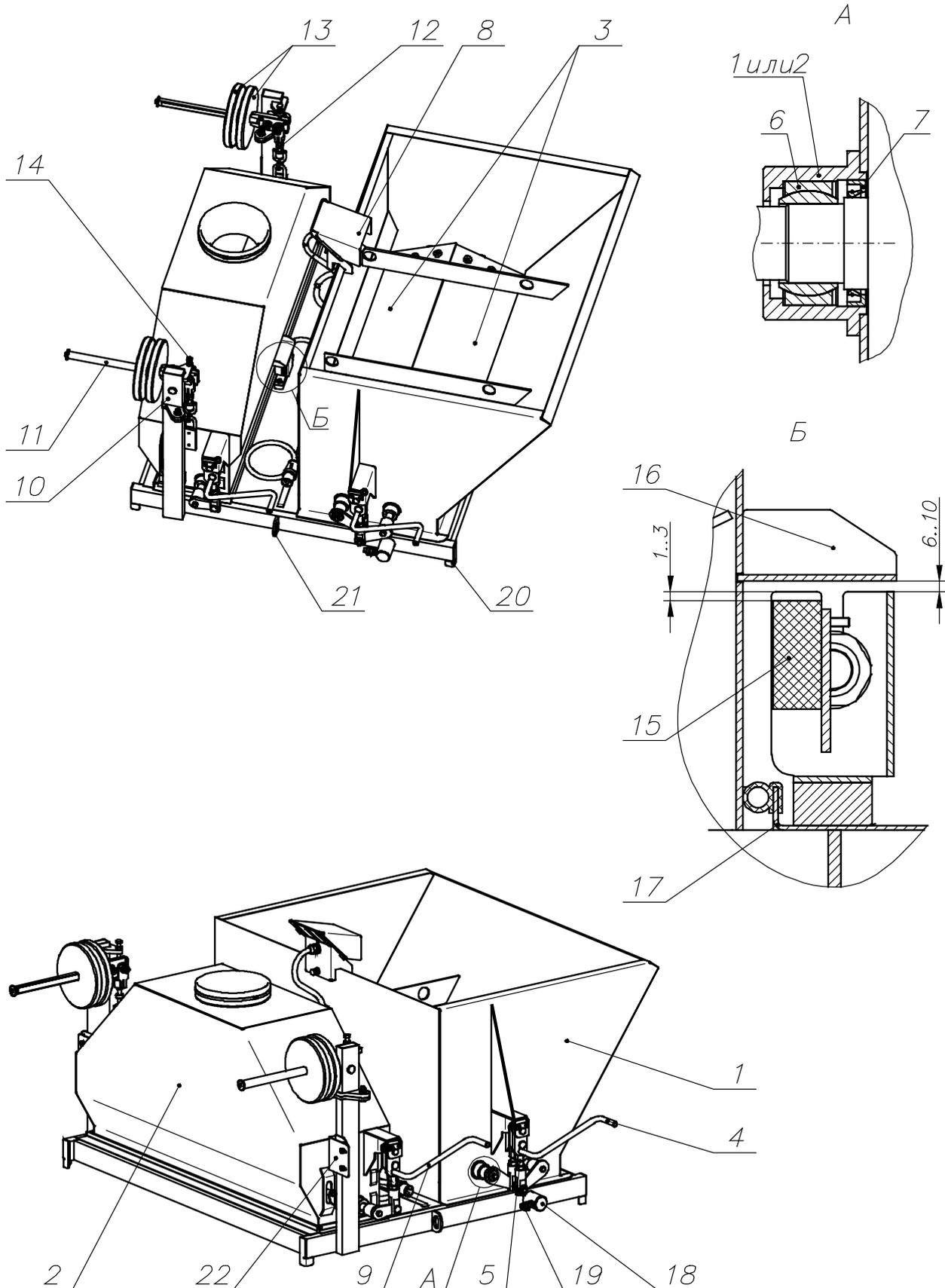
Рисунок 3. Блок дозаторов
